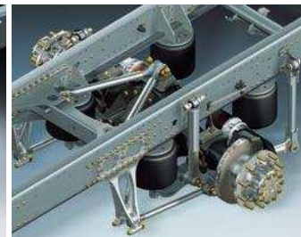
Пневматично окачване с четири амортизатора на заден мост на TGM. Като опция - задни мост за тежки режими на работа, товарносимост 11.5 тона.
