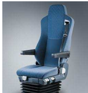
Удобна седалка на шофьора, на пневматични пружини с играна система за предпазни колани и поддържащи като опция.
