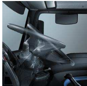
Натискането на един бутон позволява безбедно регулиране на волана на височина и ъгъл.
