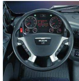
Многофункционален волан с управление на радио MAN, контрол на маршрута и т.н.
